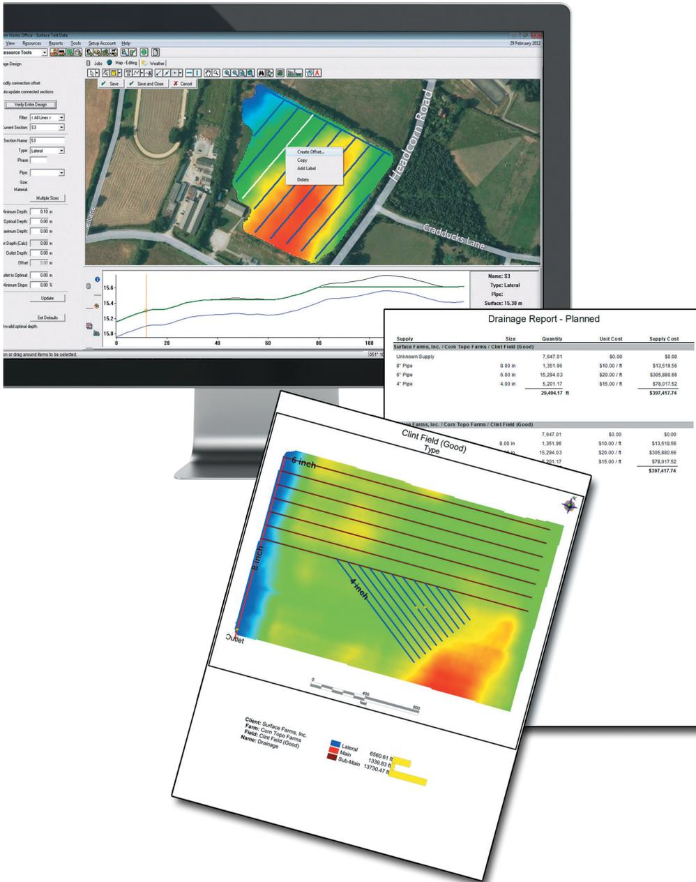
O software Farm Works - Surface é uma ferramenta de análise e desenho para uso com solução de drenagem agrícola Trimble® WM-dreno
